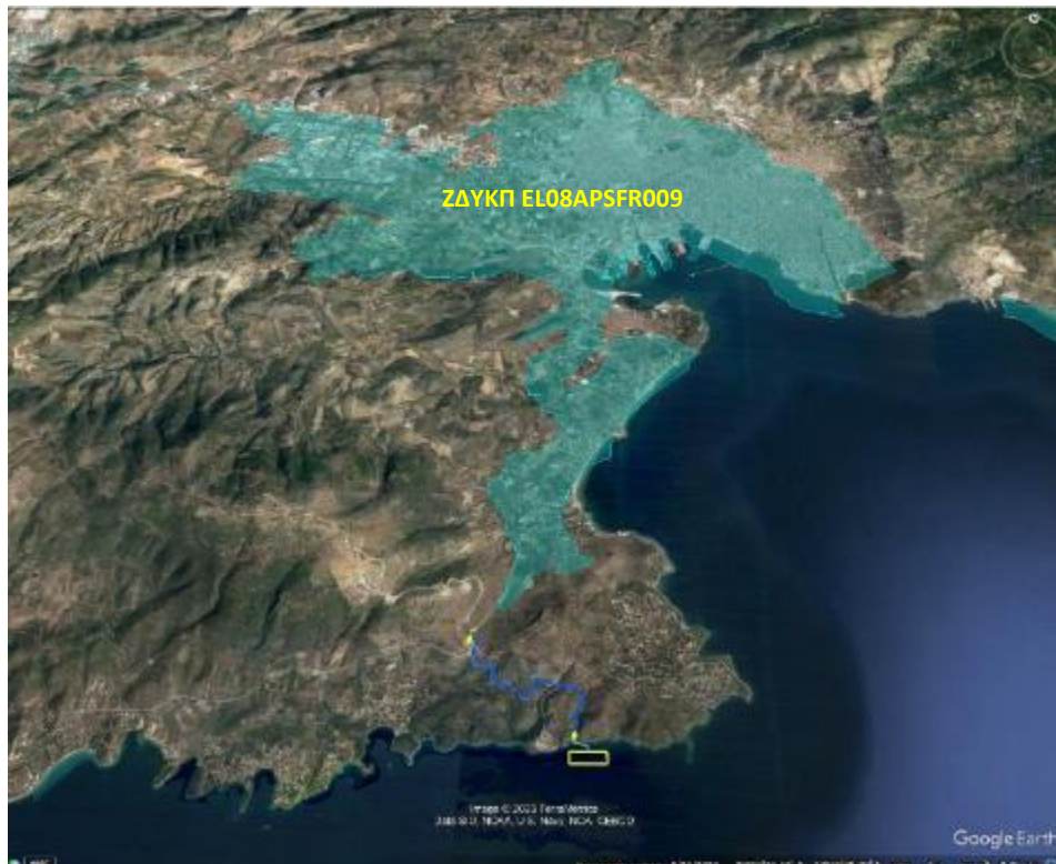
Σχήμα 5-19 Απόσπασμα Google Earth, όπου με κίτρινα πολύγωνα απεικονίζονται ο πλωτός τερματικός σταθμός, ο παράκτιος θάλαμος δικλίδων & ο σταθμός μέτρησης & ρύθμισης της πίεσης, με γαλάζιο χρώμα η όδευση των υποθαλάσσιων αγωγών & με μπλέ γραμμή η όδευση του χερσαίου αγωγού και με γαλλάζια διαγράμμιση απεικονίζεται η ΖΔΥΚΠ που γειτνιάζει το έργο.
