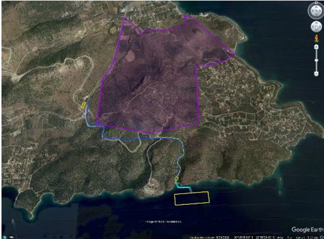
Σχήμα 8-11 Απόσπασμα Google Earth, όπου με κίτρινα πολύγωνα απεικονίζονται ο πλωτός τερματικός σταθμός, ο παράκτιος θάλαμος δικλείδων & ο σταθμός μέτρησης & ρύθμισης της πίεσης, με γαλάζιο χρώμα η όδευση των υποθαλάσσιων αγωγών & με μπλέ γραμμή η όδευση του χερσαίου αγωγού και με ματζέντα διαγράμμιση απεικονίζεται ο κηρυγμένος αρχαιολογικός χώρος που γειτνιάζει με το έργο.
