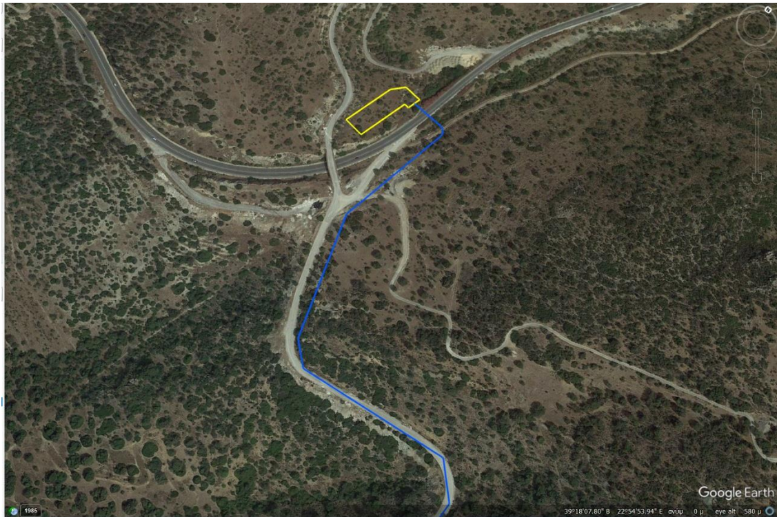
Σχήμα 6-8 Απόσπασμα Google Earth, όπου με κίτρινο πολύγωνο απεικονίζεται ο σταθμός μέτρησης & ρύθμισης της πίεσης (που δεν αδειοδοτείται με το παρόν έργο) & με μπλέ γραμμή η όδευση του χερσαίου αγωγού.
