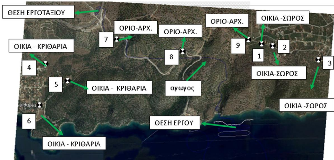
Σχήμα 9-2 Απόσπασμα Google Earth, όπου υποδεικνύεται η θέση του εργοταξίου, καθώς και οι θέσεις των σημείων ελέγχου του ακουστικού θορύβου κατά τη διάρκεια της λειτουργίας του έργου.
