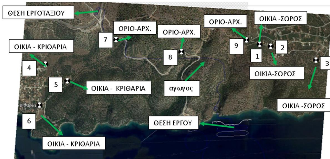
Σχήμα 6-11 Απόσπασμα Google Earth, όπου υποδεικνύεται η θέση του εργοταξίου, καθώς και οι θέσεις των σημείων ελέγχου του ακουστικού θορύβου κατά τη διάρκεια της κατασκευής του έργου.
