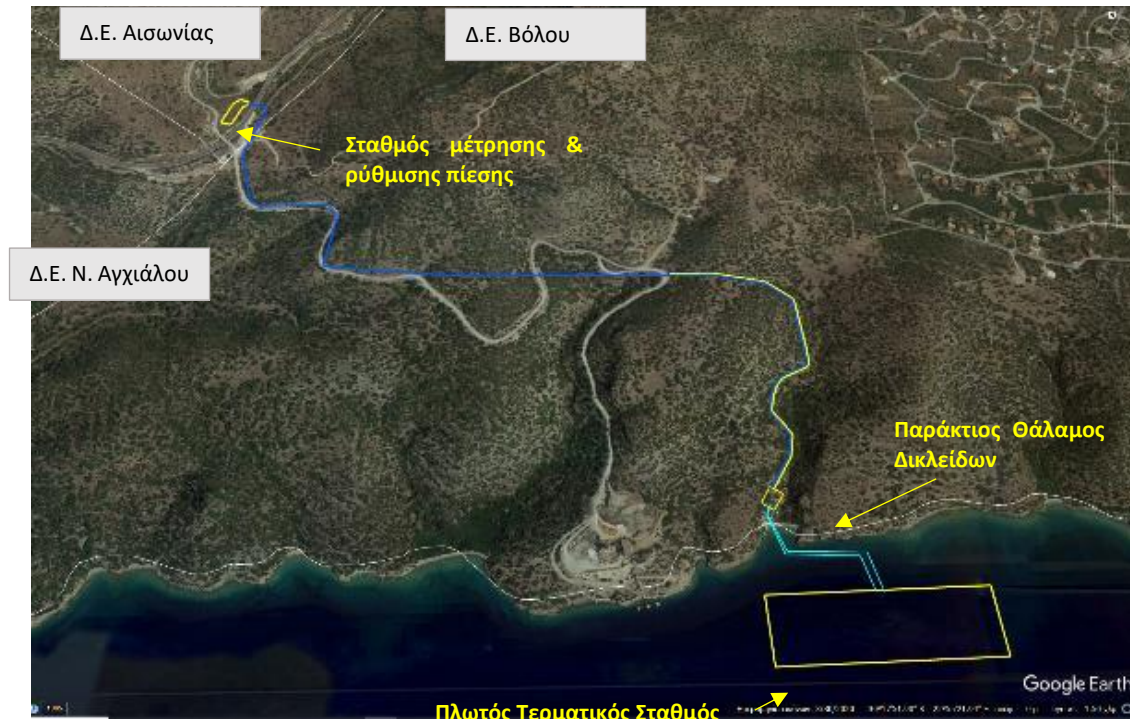
Σχήμα 2-2 Απόσπασμα Google Earth, όπου με κίτρινα πολύγωνα απεικονίζονται ο πλωτός τερματικός σταθμός, ο παράκτιος θάλαμος δικλείδων & ο σταθμός μέτρησης & ρύθμισης της πίεσης, με γαλάζιο χρώμα η όδευση των υποθαλάσσιων αγωγών & με μπλέ γραμμή η όδευση του χερσαίου αγωγού.
